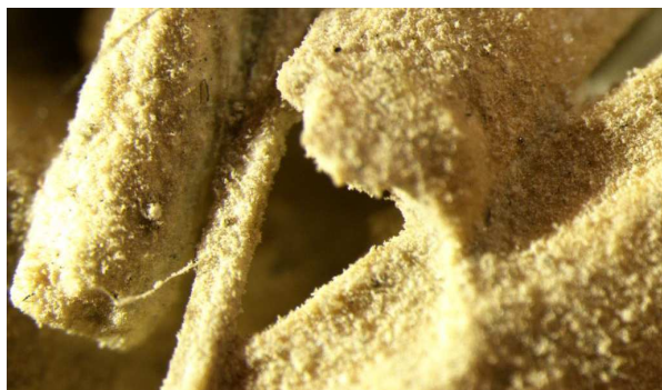
Figur 6. Kalken ligger som en skyddande hinna med kalkkristaller runt hampaveden (16x). Foto: Sanne Johansson
