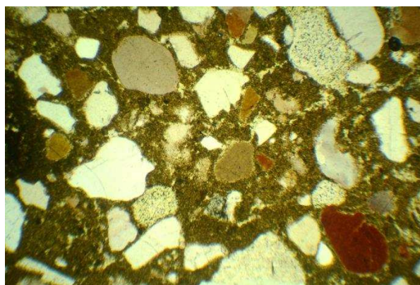
Figur 33. Prov 4Biskopen, ett homogent kalkbruk med en något grynnig kalk, ca 1:1,5.
