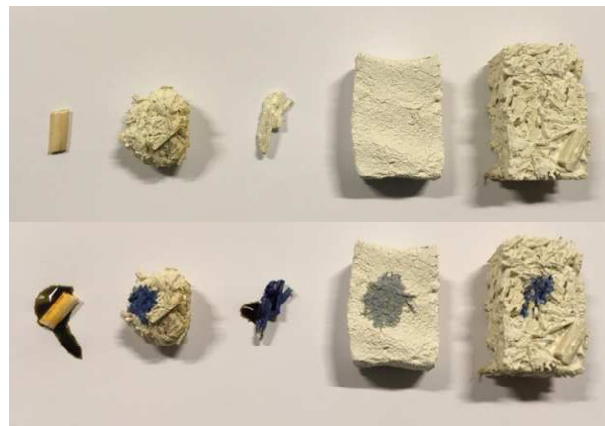
Figur 1. Provkropparna tillverkades en tid innan mätningen skulle påbörjas så att de hann genomkarbonatisera före mätning. Karbonatiseringen påvisades med indikatorämnet tymolblå. Foto: Paulien Strandberg
