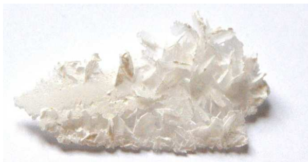
Figur 28. Makrofoto som visar kalcitkristaller som haft tid att långsamt växa till på en yta med fri tillgång på kalciumhydroxid och vatten. De stora trigonala kristallerna är ca 5 mm.
