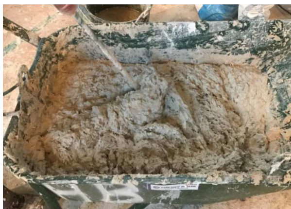
Figur 17. Konsistensen på hampakalken kan anas från bilden ovan (jämför med bruket som användes i fallstudierna). Foto: Kristin Balksten
