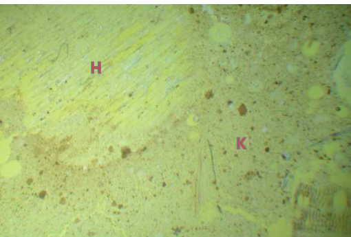
Figur 9. Hampakalk uttaget på 90-115 mm djup i vägg A, sett inifrån. Provet är ingjutet i fluorescerande epoxi varför alla håligheter syns som gula utrymmen. Polarisationmikroskopbild av tunnslip visar en homogen kalkmassa (K) som omsluter hampaskävorna (H). I kalkmassan finns små och stora runda luftporer (P), mestadels väl avgränsade från varandra. I hampaskävornas fiberriktning syns även dess egna porstruktur. Något spår av saltvittring kan inte utläsas, porerna är helt intakta och materialet har inte lösts upp inuti porerna.
