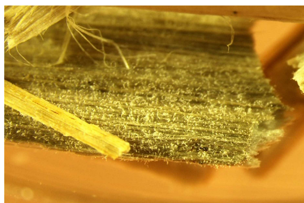
Figur 8. Efter kort tids exponering med gynnsamma förhållanden (23°C och 95 % RF) är hampan helt täckt med mögelsvampen Penicillium sp. (16x). Foto: Sanne Johansson
