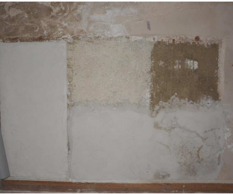
Figur 4. Utvärdering av provytor efter 1,5 år visar att putsen utanpå träullit och hampakalk saknar saltgenomslag till skillnad från putsen på lerbruk som har saltgenomslag.
