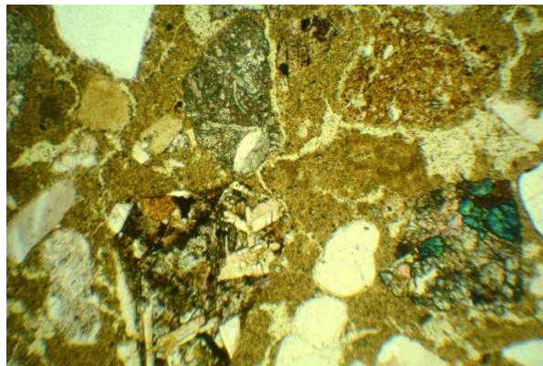
Figur 34. Prov 6Rådhuset, ett något fetare kalkbruk, med kalkklumpar och krympsprickor, ca 1:1.
