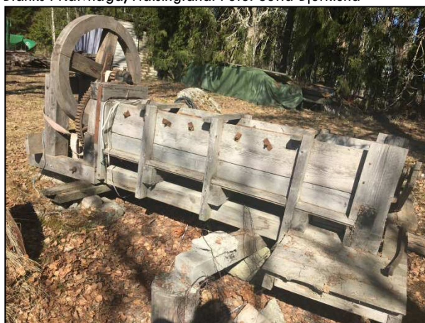
Figur 6. Lertegelmaskin från gården Blanks i Kalvhaga, Hälsingland. I karet hälls lerblandningen. Det runda trähjulet driver järnaxeln som blandar lermassan. I hålet längst till höger under karet ställs en tegelform. Den skjutsas in från ena sidan och kommer ut på den andra, fylld med välpackad lerblandning. Formen lossas därefter försiktigt och den välformade massan läggs i solen för att torka. Foto: Ellen Olsson.
