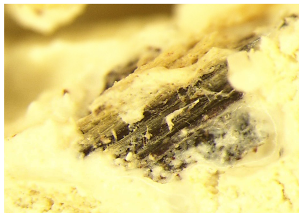
Figur 7. På ställen där kalken inte täckt hela ytan kan mögelsvampen (hyalina hyfer) lättare etablera sig på själva hampan (40x). Foto: Sanne Johansson
