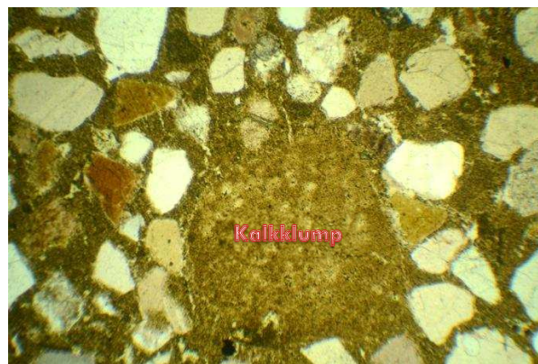
Figur 27. Prov 2Slätputs innehåller både kalkklumpar och enstaka lerkulor. Här syns en karakteristisk kalkklump.
