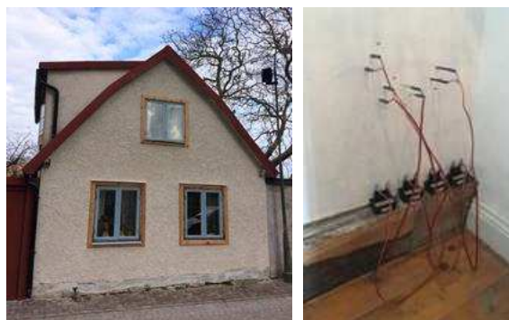
Figur 11. Byggnaden efter putsens färdigställande. Mätsondror för att logga fuktnivåer i väggen har satts in från insidan på övervåningen. Foton: Paulien Strandberg-de Bruijn
