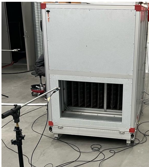
Figur 3. Mätposition Mik 2. Tilluftskanalen var inte ansluten.
