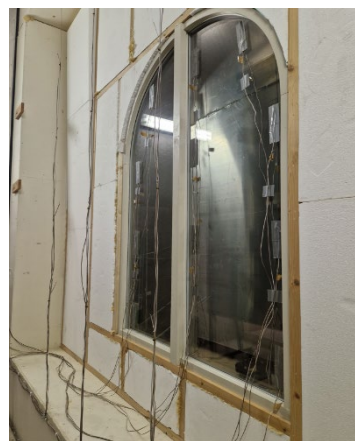
Figur 11: Principbild hotboxmätning samt foto av mätningen av fönsterkassetten
