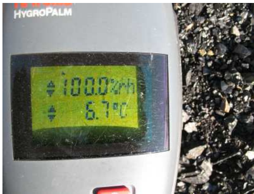
Foto 4. Mätningar kan till exempel dokumentera fukt- och temperaturvärden som är viktiga för att kunna förstå risken för skador. Även punktmätningar kan vara värdefulla, men det krävs en god kunskap om hur resultatet skall tolkas.
